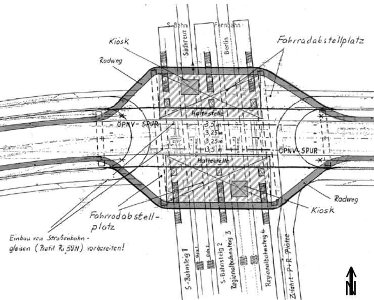
**IGEB-Vorschlag für das Kreuzungsbauwerk Buckower Chaussee mit S- und Regionalbahnhof. Erweitertes Brückenbauwerk mit Kiosk und Fahrradstellplätzen, großzügiger Überdachung (Schraffur), 3 Aufzügen an beiden Seiten, Radwegen (grau) am Brückenrand. Plangrundlage: Planfeststellungsunterlagen, Ergänzungen: M. Hasse**
