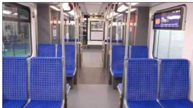
Der Mittelgang ist frei von vertikalen Griffstangen. Diese sind in den Eingangsräumen seitlich angeordnet und laden Radfahrer dazu ein, mit ihrem Fahrrad den gesamten Durchgang zu versperren. Im Gang fehlen oben horizontale Griffstangen. Foto: Marc Heller
