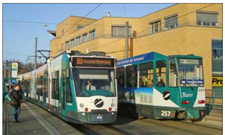
Bisher fahren in Potsdam der Typ Combino (Niederflur, links) und die modernisierten Hochflur-Tatrawagen (rechts), hier an der Haltestelle Lange Brücke. Foto: Florian Müller
