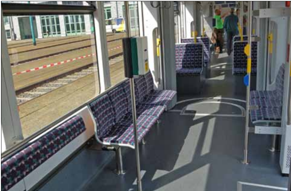
Eines der beiden großen Mehrzweckabteile mit Blick in das mittlere Fahrwerksmodul. Auffällig die Längsbestuhlung und die Stehplatzfläche, die aber zu wenige Festhaltungsmöglichkeiten bietet. Foto: Michael Dittrich
